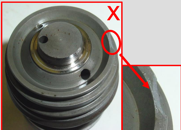
Zniekształcenia korpusu zaworu → zwrot nie akceptowalny
