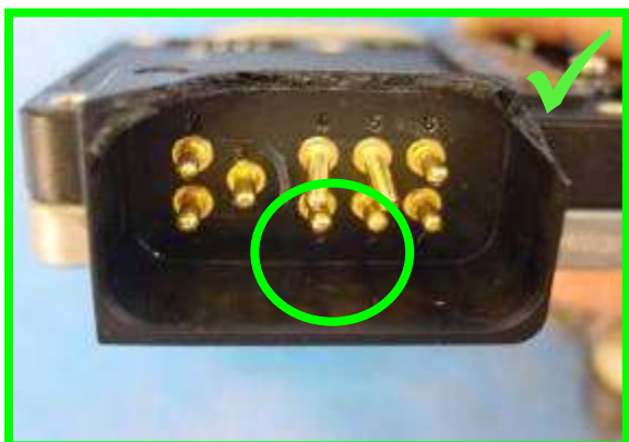
Uszkodzone piny → dopuszczalne
