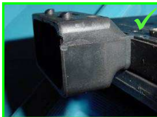
Nieznacznie uszkodzona wtyczka max 2mm → dopuszczalne
