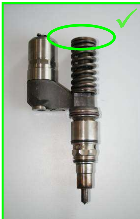
Brak trzpienia przy talerzyku sprężyny → dopuszczalne
