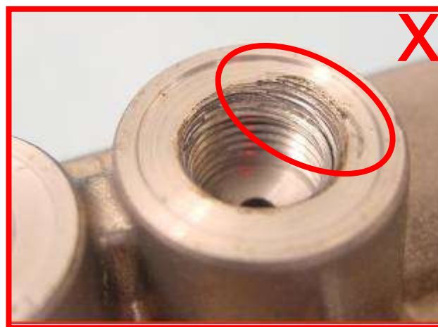
Uszkodzenia gwintów → niedopuszczalne
